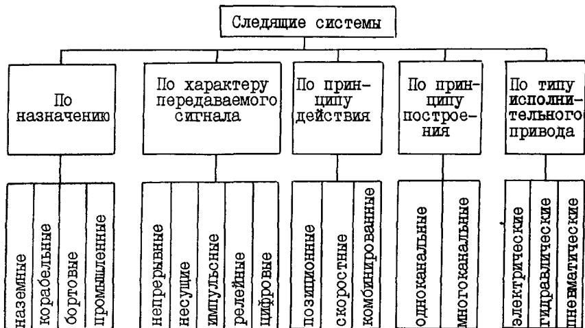
Рис.2. Классификация следящих систем
